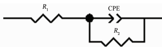
图 5 电化学阻抗谱的等效电路
