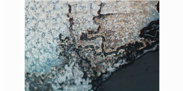
(a) 内壁焊缝小凹坑附近腐蚀形貌(200×)
