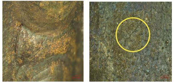
(b) 焊缝腐蚀形貌
