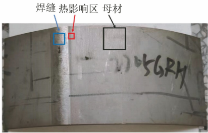
图 1 焊接接头不同区域的取样示意
