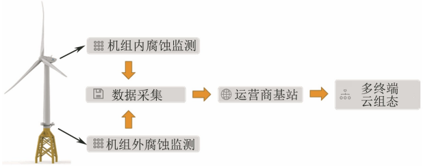
图 1 海上风机腐蚀在线监测系统的数据传输
