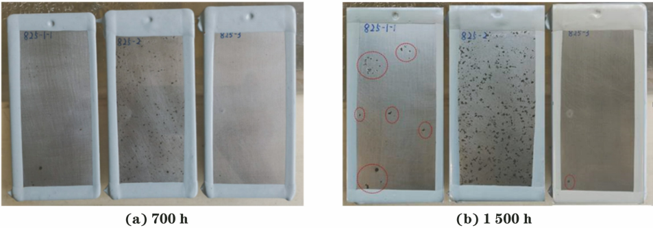
图2 盐雾腐蚀 700 h 和 1 500 h 后各涂层表面宏观形貌(左 PAE, 中 GO/PAE, 右 PSGO/PAE)
