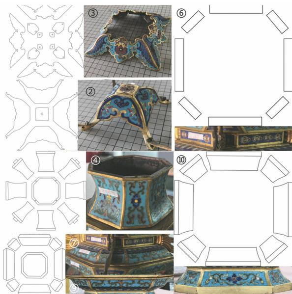
图 10 多面合围组合结构
